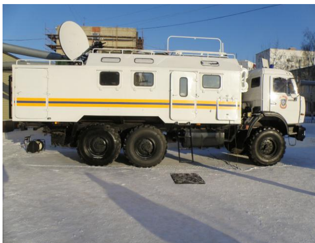
Рис. 6.16. Мобильный узел связи
