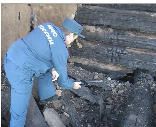
Рис. 2.20. Обследование места возникновения очага пожара сотрудниками ГПН
